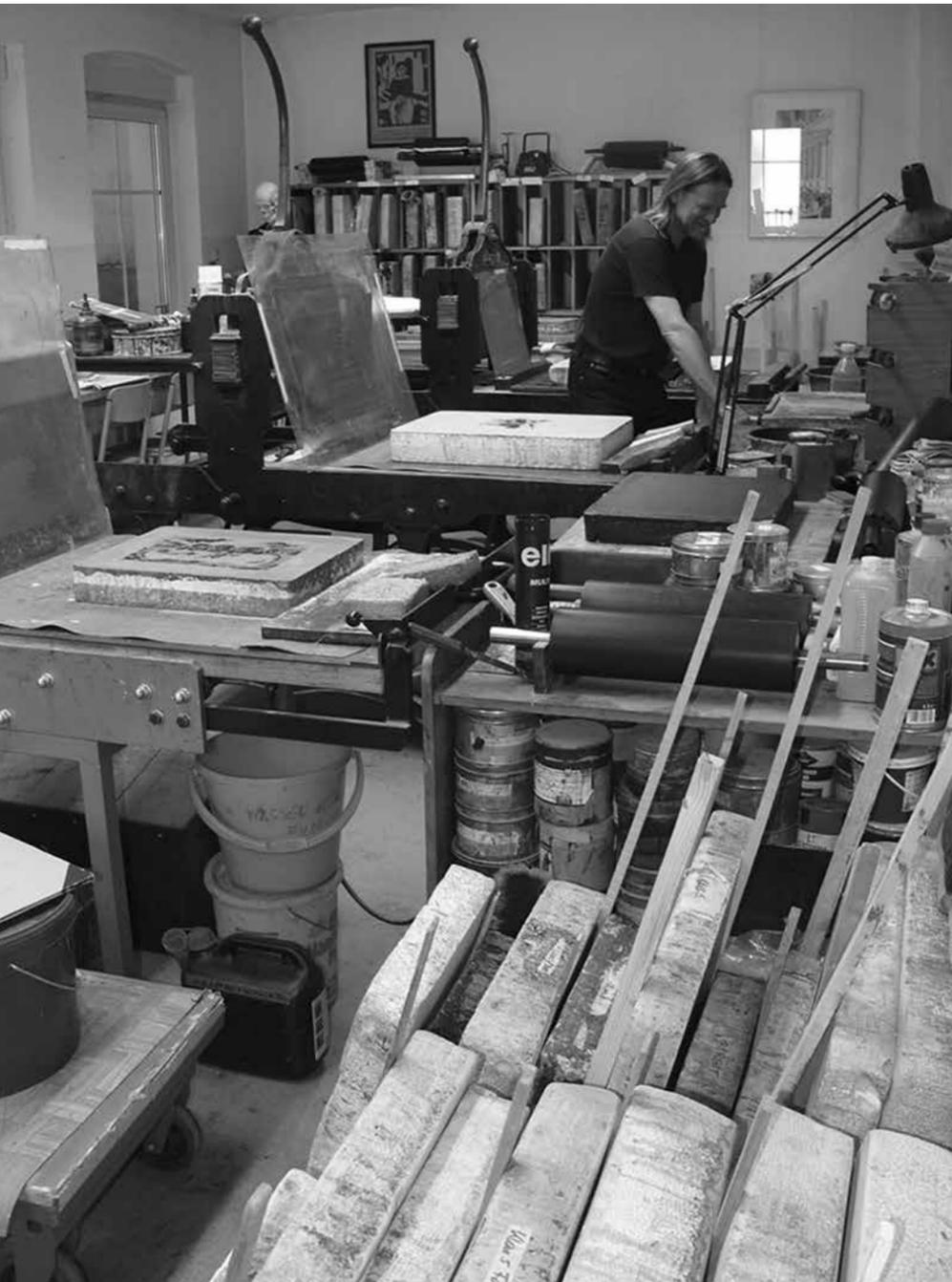
Ein Blick in die Werkstatt zeigt die Druckmaschinen und die unverzichtbaren Solnhofer Kalksteine.
