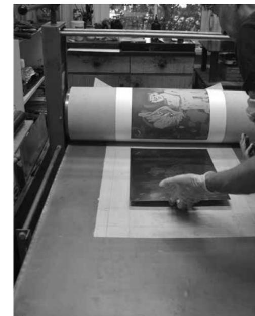
Einlegen der Druckplatte in die Radierpresse. Mit viel Gefühl und Erfahrung wird die Maschine mit Hand geführt.
