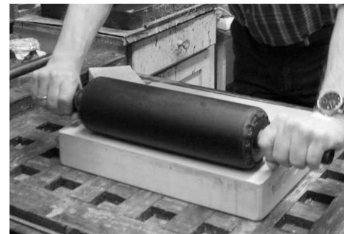
Der Stein wird mit Federfarbe angewalzt, die speziell für die Lithographie entwickelt wurde und für die Präparation wichtig ist.
