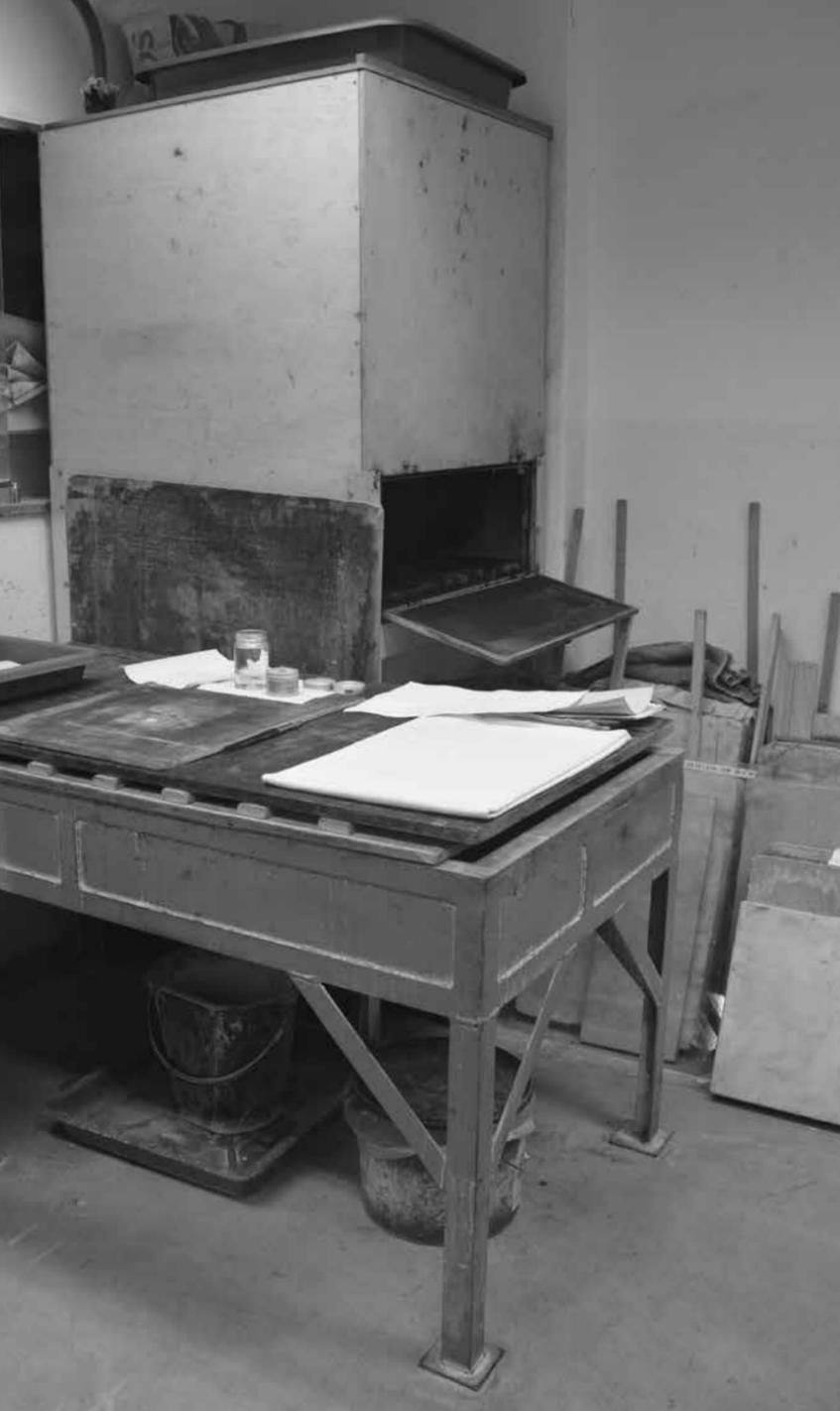
Der Staubkasten ist für extra große Druckplatten gebaut, für eine gleichmäßige Verteilung von Asphaltstaub.
